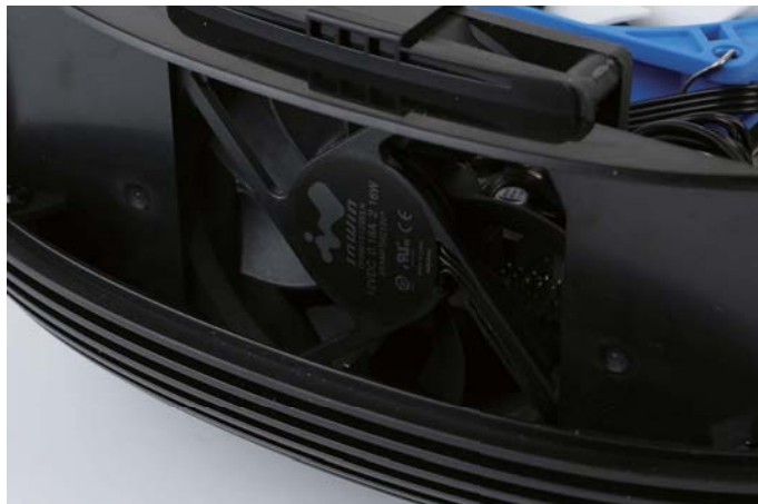
预装了一个80mm的散热风扇
