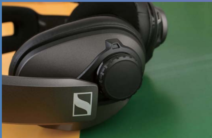
森海塞尔GSP370无线游戏耳机的右侧单元提供了一个音量滚轮，滚轮刻度明显，每一下调节2个单位的音量大小。
