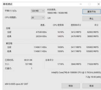
在相同测试设定下，总容量为16GB双通道内存套装的7-Zip的总体评分为71028MIPS。
