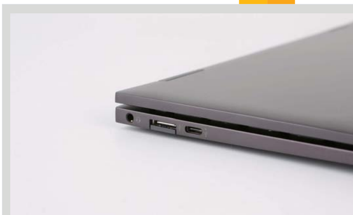
>> 左侧的 USB-C 接口支持 PD 充电
