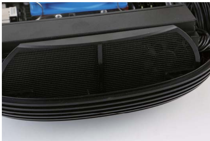
电源一侧的外部设计有防尘滤网
