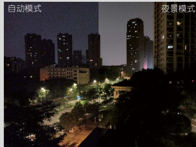
>> 夜景模式下荣耀 Play4 可以通过延长曝光时间来提升场景亮度，以达到更好观感。
