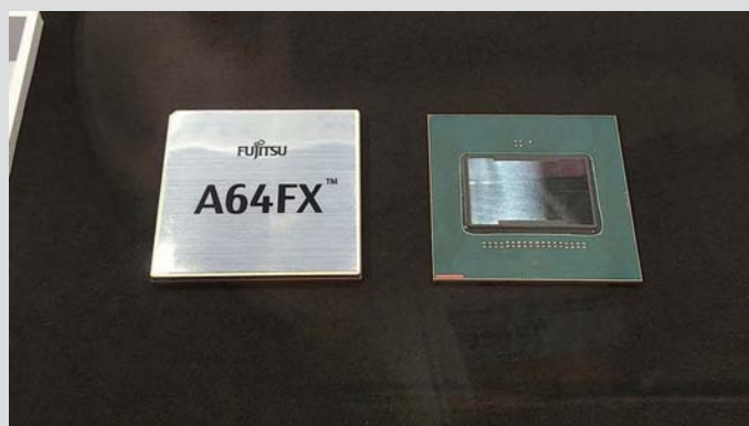
■ A64FX处理器上盖和芯片照片
