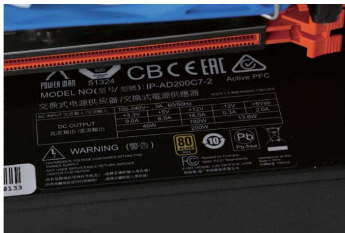
■ 内置有一个额定功率200W的80PLUS金牌电源
