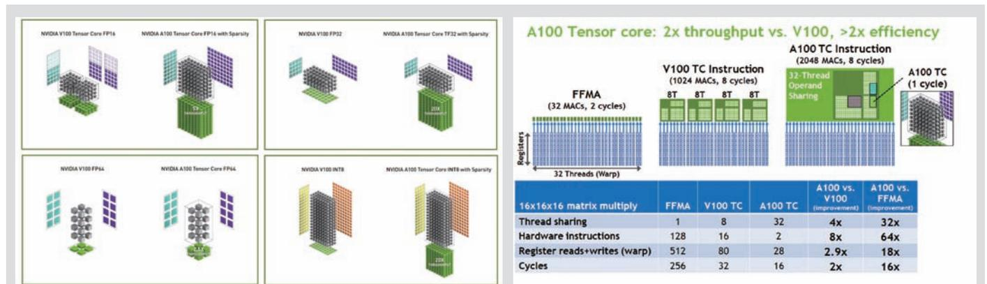
A100的第三代张量核心在计算不同类型任务时相对V100的进步幅度。
