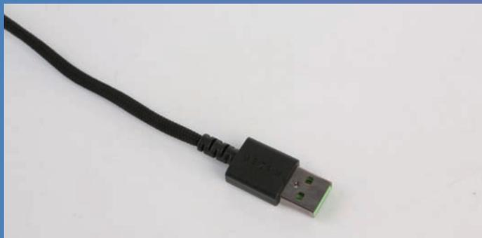
■ Razer炼狱蝰蛇V2迷你版游戏鼠标的连线部分采用了Razer SpeedFlex超柔线缆，并且接口内芯进行了绿色喷涂处理。
