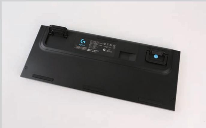
罗技G913 TKL无线RGB机械键盘的底部采用了硬塑料材质，并且除了必要的支脚、脚贴、铭牌之外，还预留了一个USB收纳仓。
