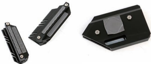
■ ROG STRIX B550-E GAMING主板采用了完整覆盖MOSFET、电感、芯片组的散热模块,并通过特制导热贴快速导出热量,值得一提的是,B550芯片组不再需要加装风扇主动散热,静音性更好。
