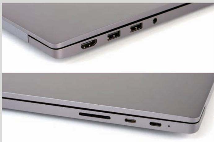
>> 这款轻薄本左右两个共配备了两个USB-C接口、两个USB-A接口、一个HDMI接口和一个SD卡插槽
