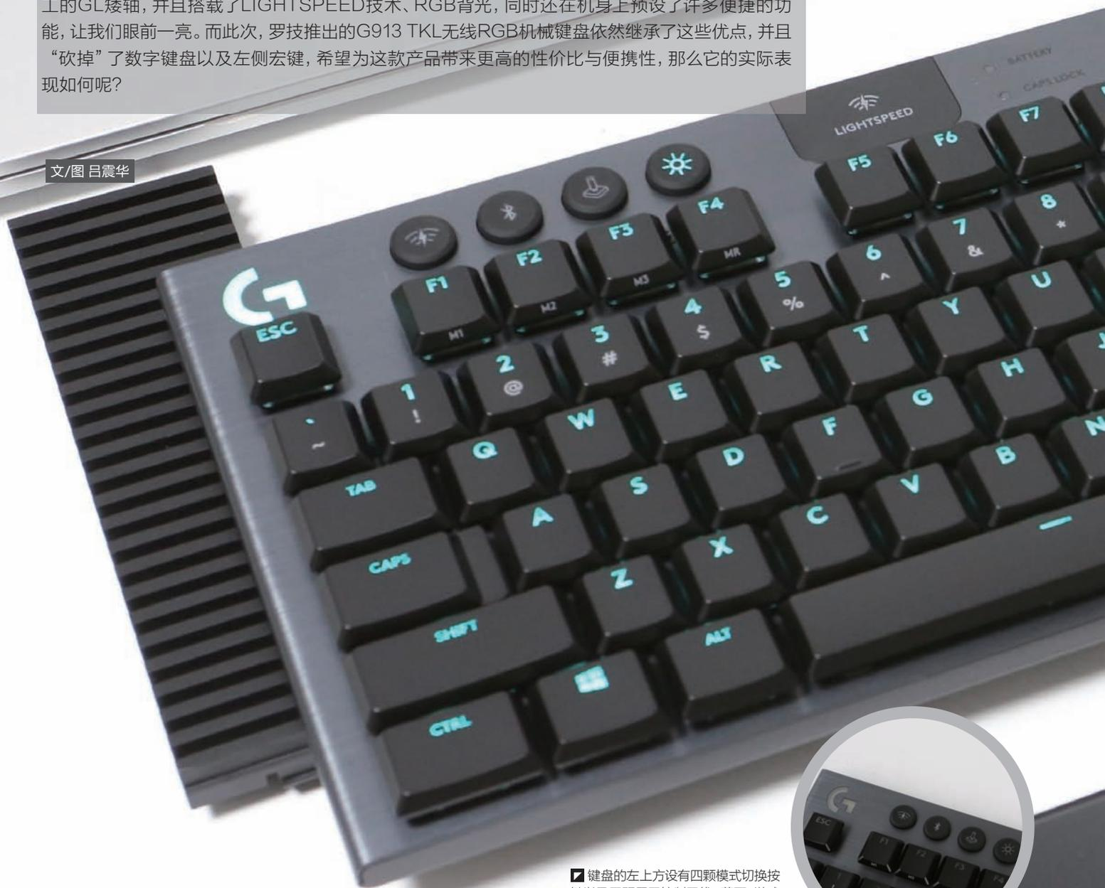
■ 键盘的左上方设有四颗模式切换按键以及四颗用于控制无线、蓝牙、游戏模式、背光开关的功能键。
