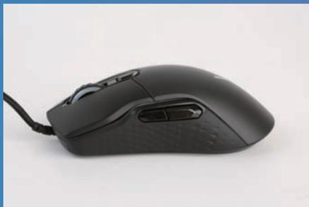
鼠标左侧拥有一块面积巨大的防滑侧裙,同时上面还有两颗侧键。
