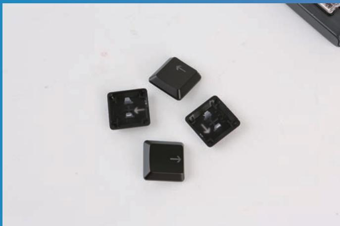
比起传统的OEM键帽，罗技G913 TKL无线RGB机械键盘的ABS透光键帽采用了半高设计。
