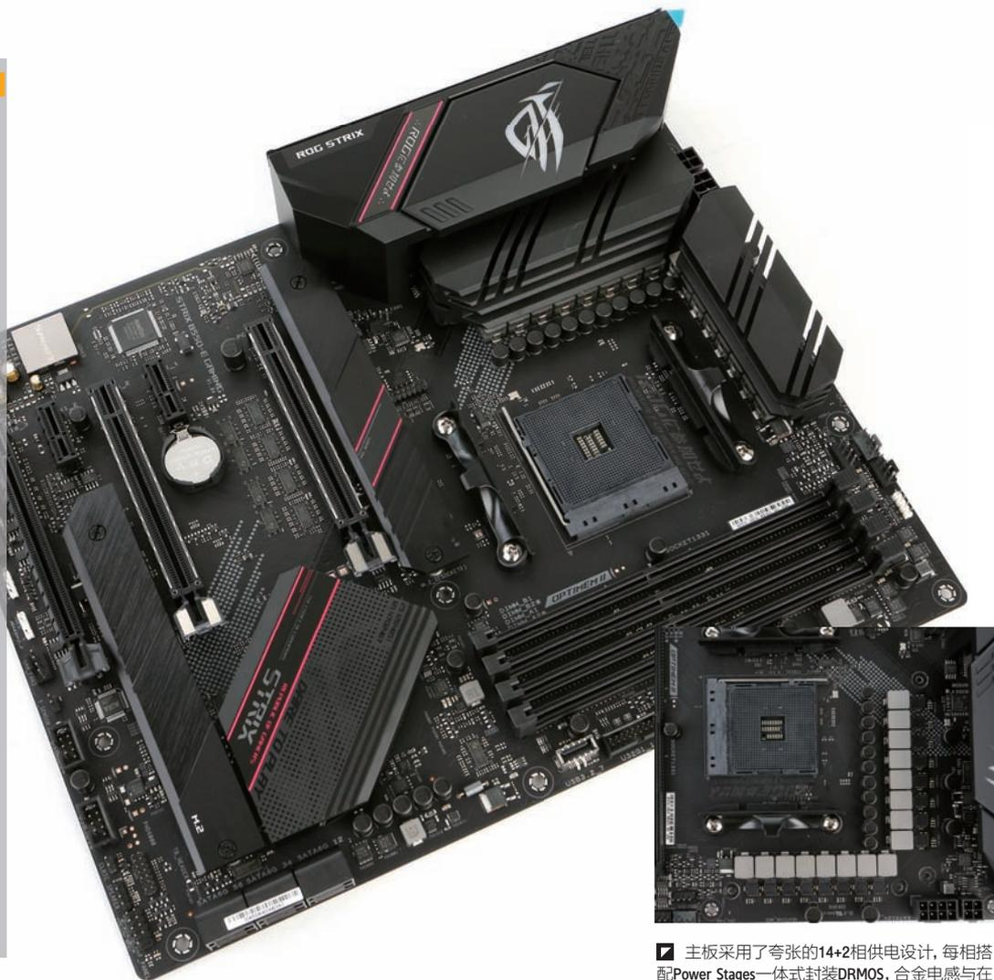
■ 主板采用了夸张的14+2相供电设计，每相搭配Power Stages一体式封装DRMOS，合金电感与在105°C温度环境下拥有5000小时工作寿命的5K固态电容。
