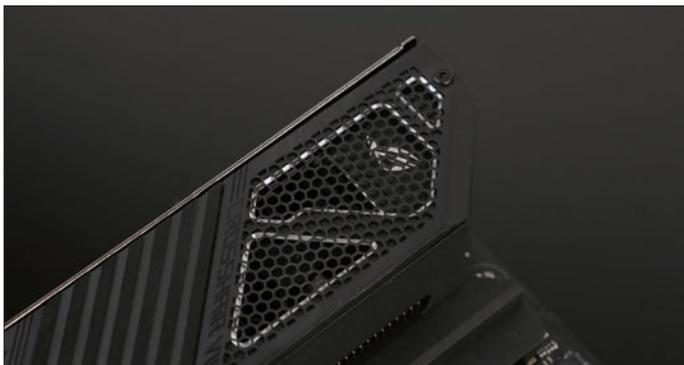
■ 这款主板的一体式I/O装甲中配备了两个小型散热风扇, 它们的主要任务是给X570南桥芯片和供电电路进行散热(图中为供电电路的散热风扇)。
