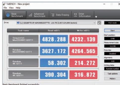
❑ PCIe 4.0 x4 SSD在B550主板上可以发挥出巨大的威力
