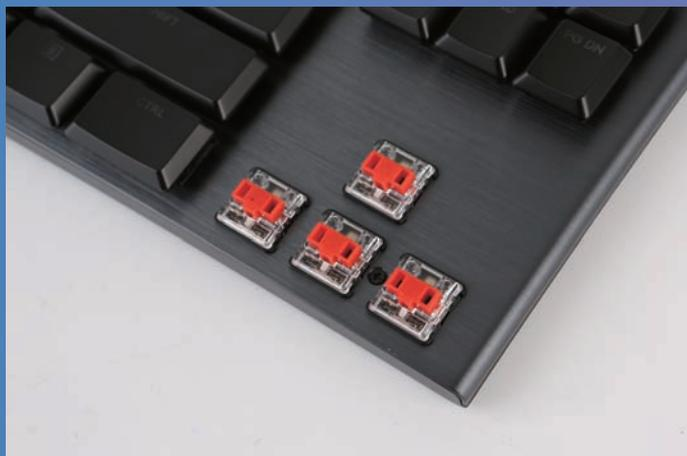
评测的这款罗技G913 TKL无线RGB机械键盘采用了GL-L矮轴
