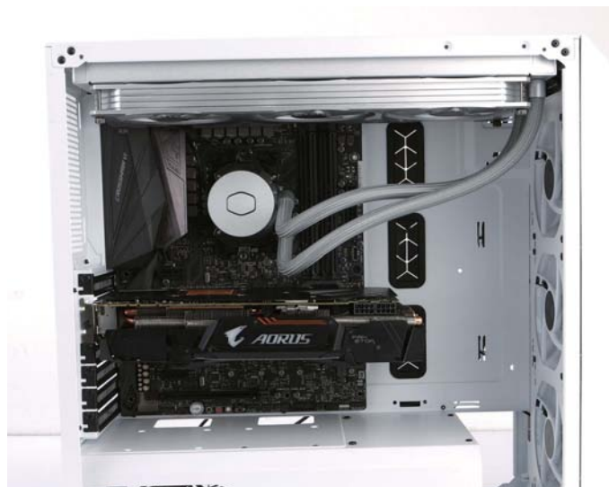
在安装了主板、显卡、散热器后，可以看到内部空间依然有很大的富余。
