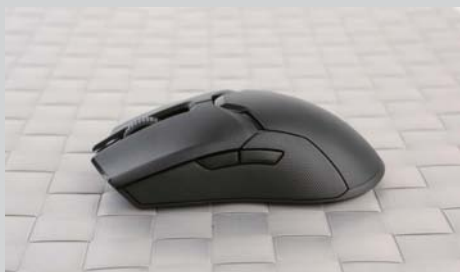
Razer毒蜂终极版游戏鼠标的左侧拥有一块面积巨大的防滑侧裙，同时侧裙上方有着两颗侧键。
