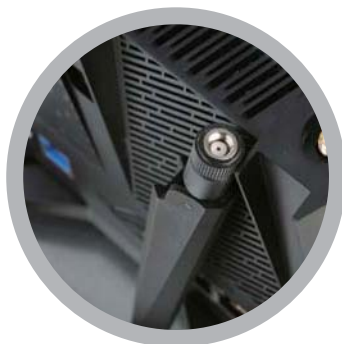
■ 三根可拆卸式的外置天线，内部还有一根天线用于增强5G信号。
