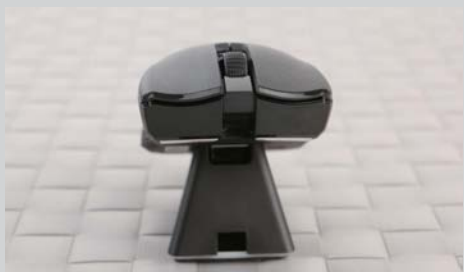
从Razer毒蜂终极版游戏鼠标正面看，我们可以发现这款鼠标采用了对称式设计，并且其正下方设计了一个Mini USB接口。
