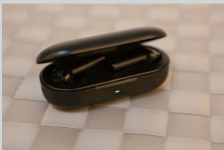
■ 在使用或充电时，充电盒的正面有一个信号灯为玩家提供指示。
