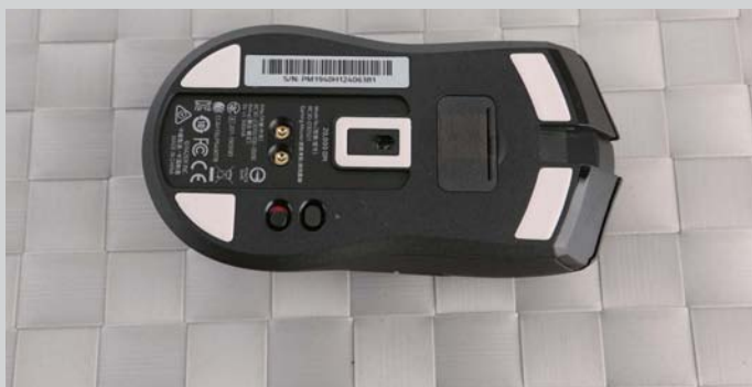
Razer毒蜂终极版游戏鼠标的底部设计是比较丰富的，除了必要的脚贴之外，还设计了USB收纳仓、充电触点、电源开关与CPI切换键。
