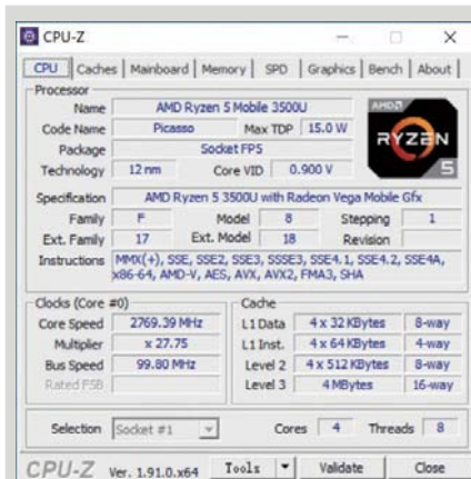
>> AMD 锐龙 5 3500U 处理器采用四核心八线程设计，基础频率 2.1GHz，加速频率 3.7GHz。
