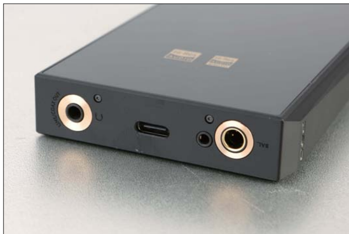
■ 机身底部的接口区，包括了2.5mm平衡、3.5mm平衡以及4.4mm平衡三种接口，齐全的配置能解决玩家“要哪一个”的困扰。中央的双向USB Type-C接口，支持USB存储、充电、USB Audio、USB DAC，并兼容PD2.0充电器。
