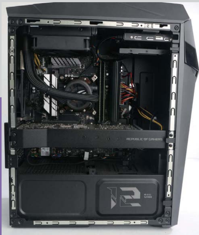
▣ 机箱内部的散热风道设计也非常合理，CPU部分采用了定制的一体式水冷设计，散热性能更优秀。
