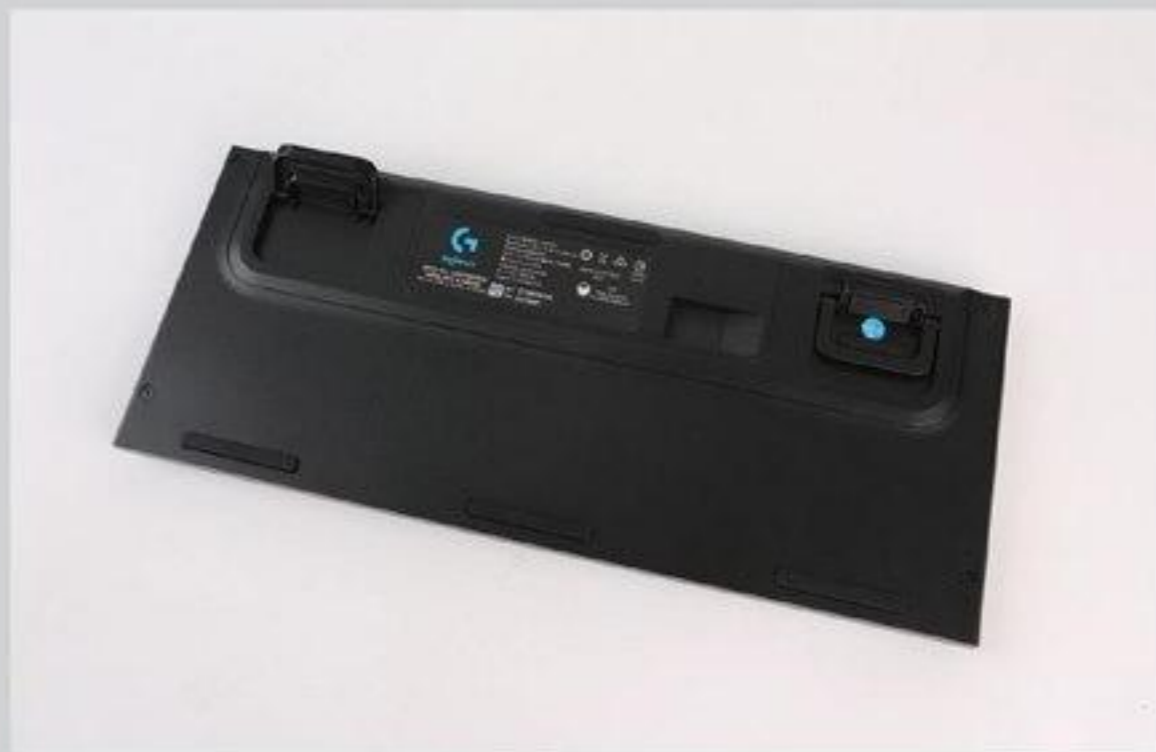
罗技G913 TKL无线RGB机械键盘的底部采用了硬塑料材质,并且除了必要的支脚、脚贴、铭牌之外,还预留了一个USB收纳仓。
