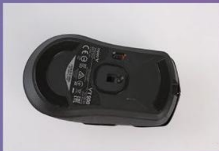
除了铭牌与脚贴之外, 鼠标的底部还设计了一个电源开关。
