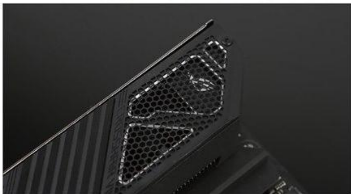
这款主板的一体式I/O装甲中配备了两个小型散热风扇, 它们的主要任务是给X570南桥芯片和供电电路进行散热(图中为供电电路的散热风扇)。
