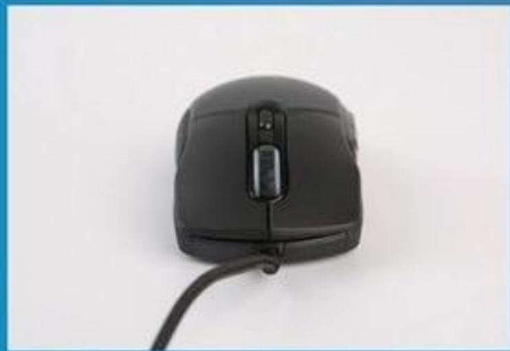
从鼠标正面看,可以发现雷柏VT200游戏鼠标的尺寸偏对称式设计,同时鼠标左右按键采用了分体式设计。
