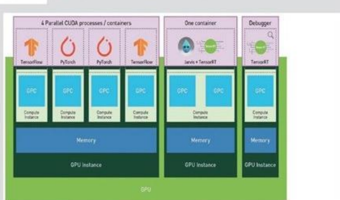
■ 利用MIG技术,不同任务可以运行在不同的虚拟GPU上。
