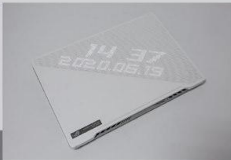
让AniMe Matrix光显矩阵屏显示系统时间，关闭盖子后有点像手机“息屏显示”功能。
