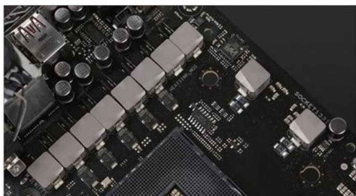
这款主板采用8+2相供电电路，并使用了TDA21472 MOSFET、粉末化超合金电感和日系FP10K黑金固态电容等高品质元器件。
