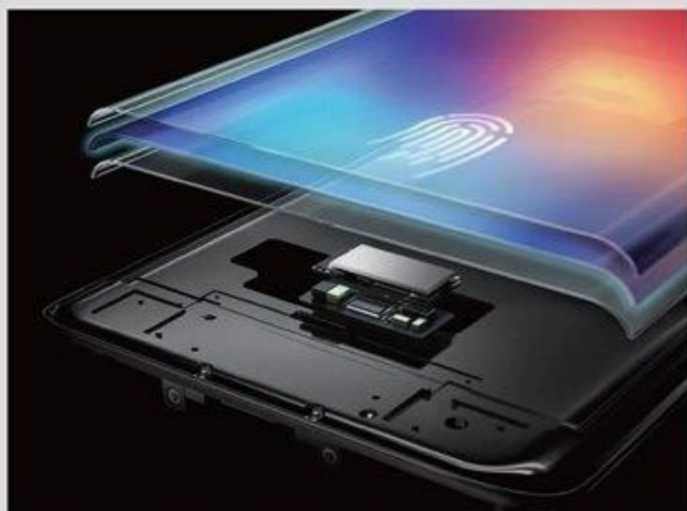
■ 屏幕指纹识别需要借助屏幕下的摄像头，原理与屏下摄像头类似，逐渐取代了实体指纹模块。
