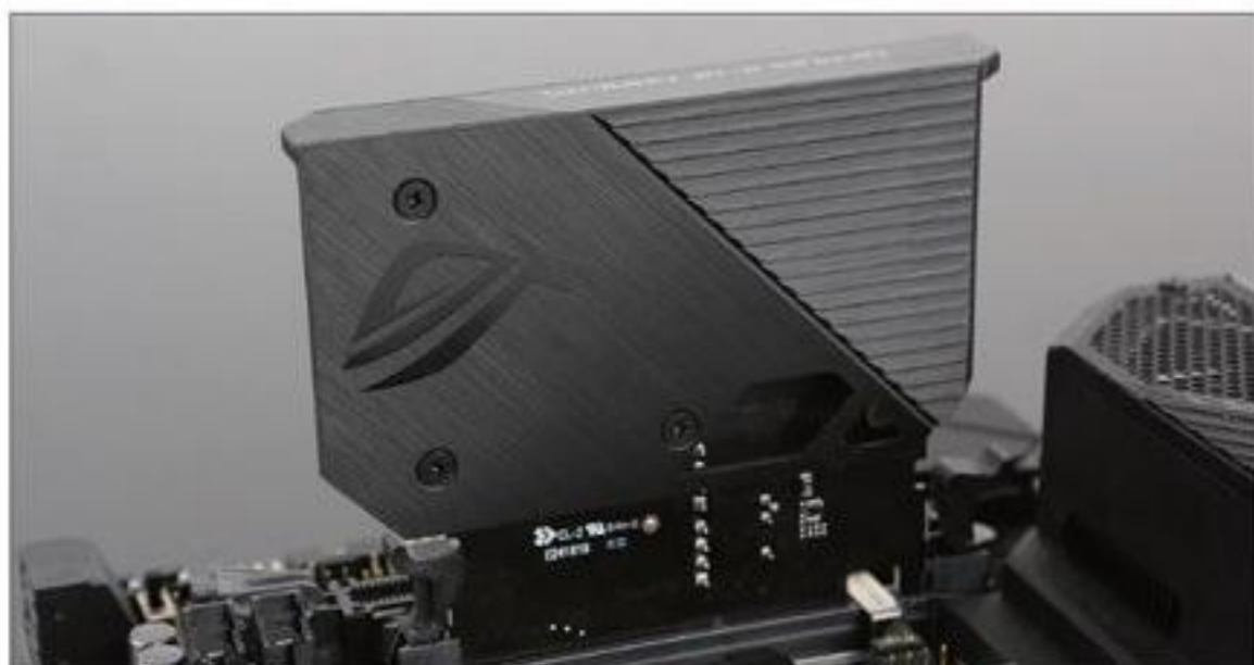
这款主板附赠一张SO-DIMM.2扩展卡, 它提供了两个拥有PCIe 4.0 x4规格的M.2 SSD插槽。
