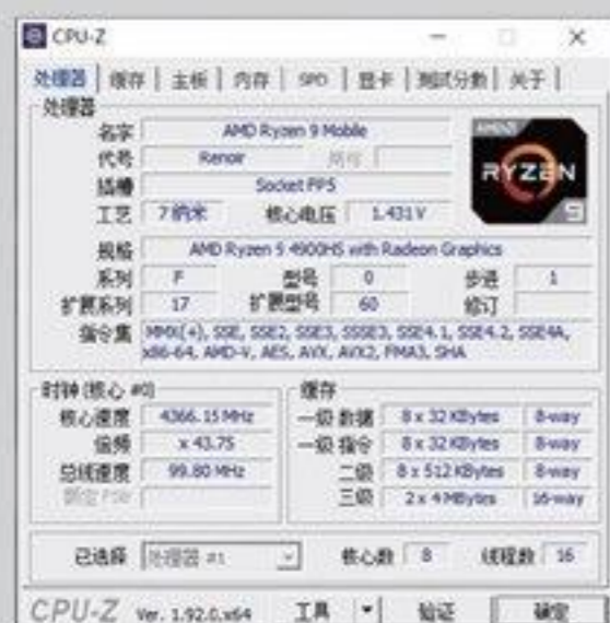
锐龙9 4900HS处理器拥有8核16线程,基础频率为3.0GHz, TDP为35W。
