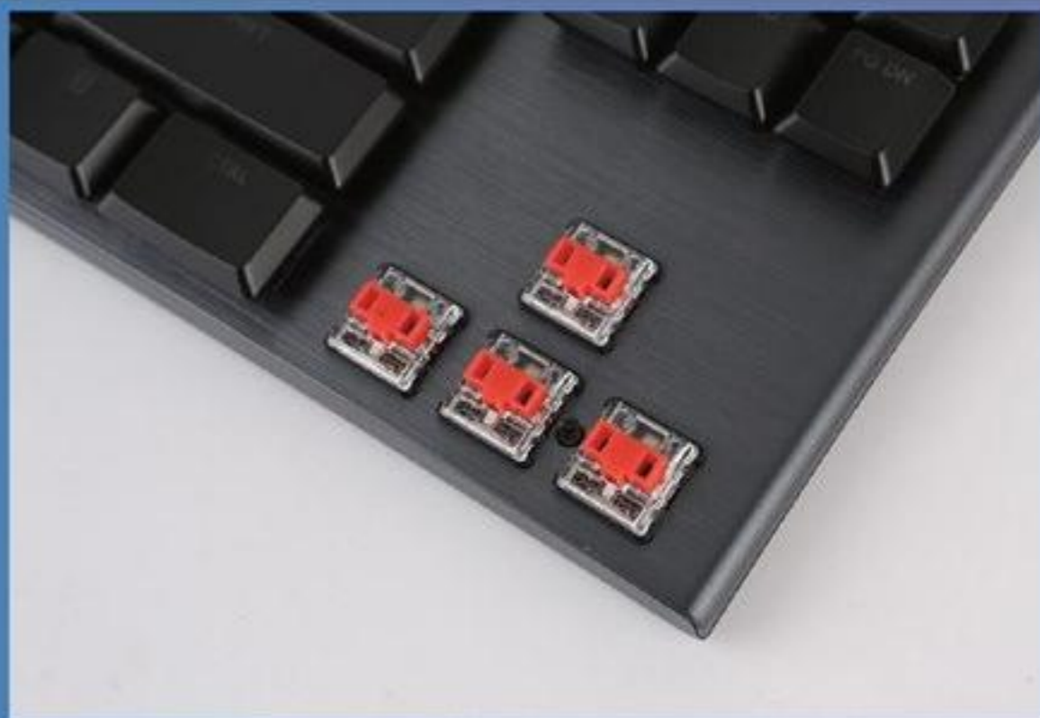
评测的这款罗技G913 TKL无线RGB机械键盘采用了GL-L矮轴
