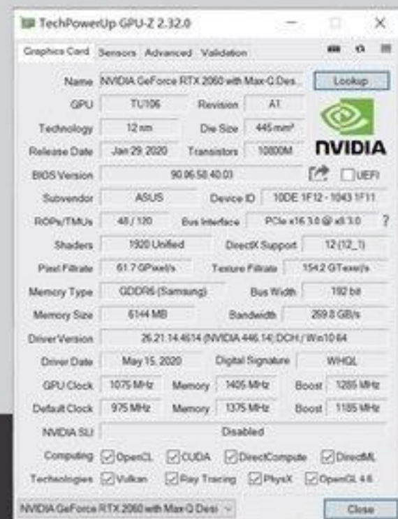
RTX 2060 Max-Q显卡采用6GB GDDR6显存,拥有1920个流处理器。
