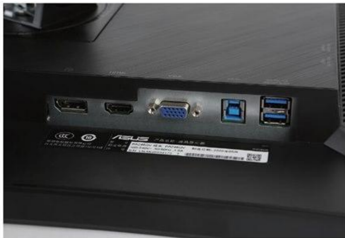
除了拥有HDMI和DP接口外，哪怕是面临淘汰的VGA接口也有配备。
