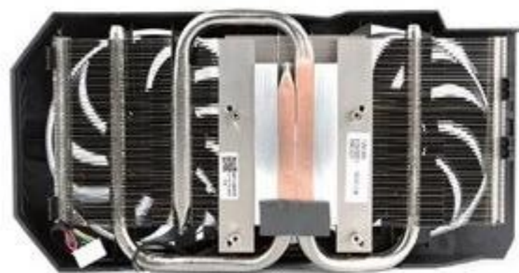
>> 这款显卡的散热器内部配备了两个导热管和大量散热片,右边则是这款显卡的Q模式(静音模式)和P模式(性能模式)的切换开关。
