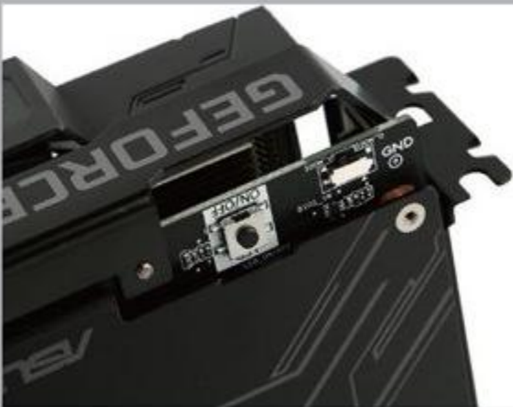
>> 这款显卡背板的右上角设有两个开关,左边是RGB LED灯的开关,
