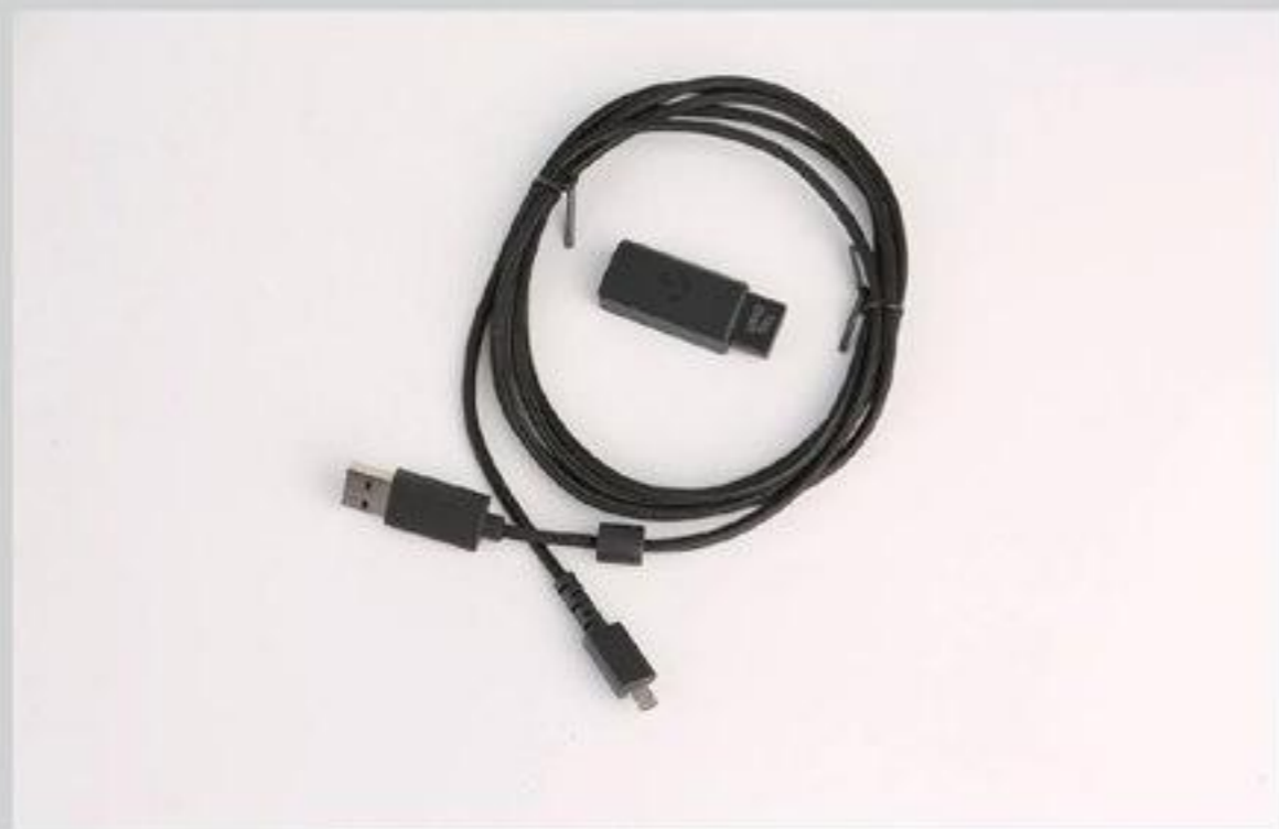
配件还包含一条USB编制线以及一个2.4GHz无线收发器
