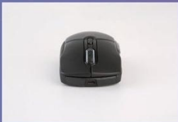
由于支持2.4GHz无线连接, 雷柏VT200双模版游戏鼠标的正面设计了一个Micro USB充电接口。
