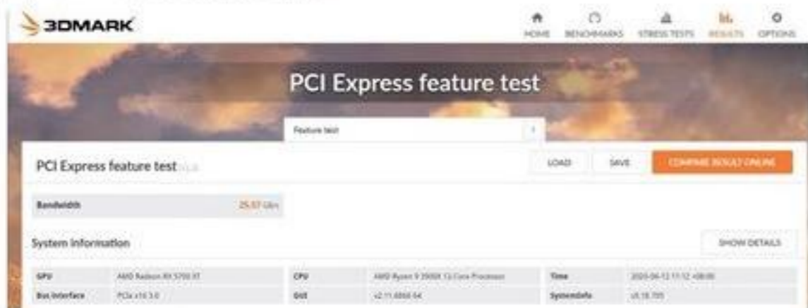
❑ PCIe 4.0显卡在ROG STRIX B550-E GAMING这类主板上的传输带宽可以达到25.57GB/s (注：软件仍错误识别为PCIe 3.0 x16)
