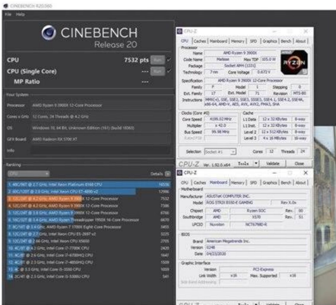
超频到全核心4.2GHz后, AMD锐龙9 3900X的CINEBENCH R20处理器多核心渲染性能突破了7500pts。
