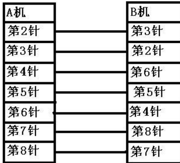
25 针对 25 针的串口线采用 2—3、3—2、7—7 的方法焊接。
