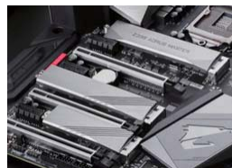
超强防护, 显卡插槽全部配备合金装甲, M.2 插槽全部覆盖散热装甲
