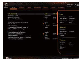
Core i9 9900KS 在 Z390 AORUS MASTER 的配合下很轻松就能超到全核心 5.3GHz
