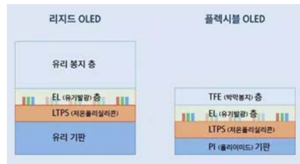
柔性 OLED 则使用 PI (聚酰亚胺) 作为下基板，代替刚性 OLED 中的玻璃基板
