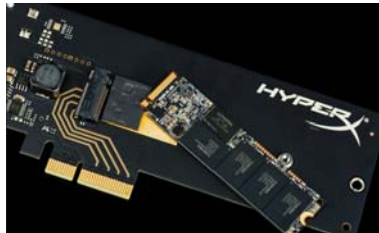
金士顿 HyperX Predator 就是典型的 PCI-E 转接卡+M.2 NVMe SSD 的组合
