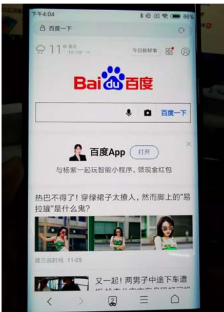
同样采用早期 LGD 面板的小米 Note2，边缘也出现了明显的绿光
