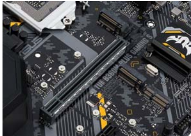
板载 3 个 M.2 插槽,其中一个 Intel CNVi 无线模块专用,另两个可以支持最高 32Gbps 带宽的固态硬盘
