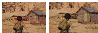
关闭垂直同步,帧速高于刷新率就会出现画面撕裂 开启垂直同步可避免画面撕裂,但遇到帧速突降会出现卡顿
