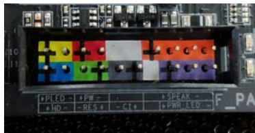
前置面板插座旁边都标明了针脚定义,如果没有,查说明书就好
