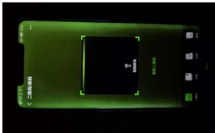
Mate20 Pro 的这块屏幕在显示灰色内容的时候，四周边框位置会出现一圈淡淡的绿光
