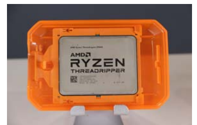
第二代 AMD 锐龙 Threadripper 依然采用 TR4 接口, 封装和一代一样都是巨无霸
