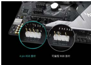
虽然插座外观相似,但常规灯带和可编程灯带插座引脚定义和电压完全不同
