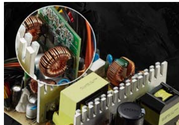
金牌电源采用 DC-DC 稳压设计,输出误差率不超过 1%
