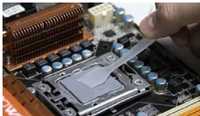
硅脂只需要均匀地涂抹薄薄的一层即可，太多太少都会影响散热效果
