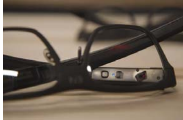
位于右侧镜架的 VCSEL 激光发射器
