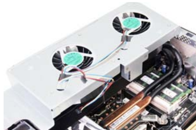
散热器方面也沿用了笔记本热管+散热风扇的设计思路,实现了扁平化,更好地利用内部空间,有利于小型化。当然,在风扇尺寸上比笔记本的要大一点,效率也还不错
