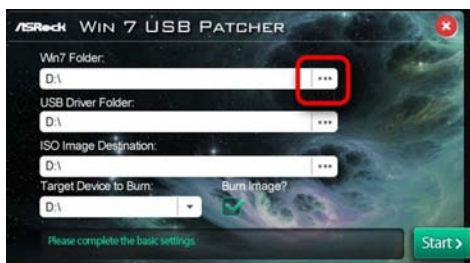
通过华硕 Win7 USB 补丁软件,可以为 Windows7 安装 U 盘打上 XHCI 驱动
