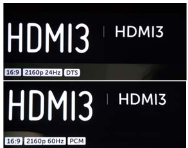
是否打开 24Hz 模式，对视频输出的刷新率有直接的影响
