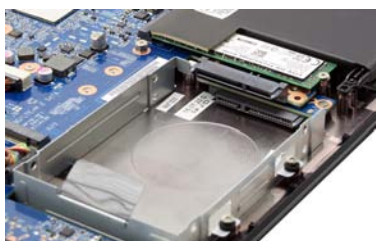
雷神 ST-Pro 预留了 2 个 2.5 英寸 SATA 接口, 想要同时使用的话就必须选择 7mm 的超薄款硬盘
