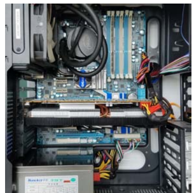
模组化电源可以选择最少的供电线材,保证机箱内散热风道通畅
