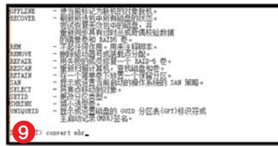
使用系统自带的工具转换分区格式,apt和mbr可自由转换
