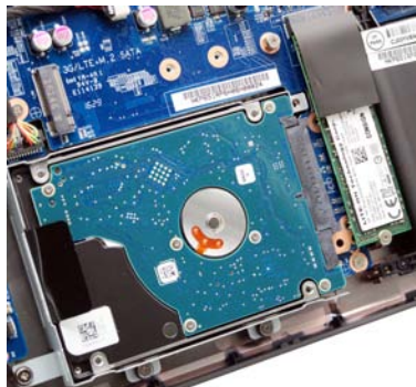
雷神 ST-Pro 比较人性化地设计了硬盘固定框架, 装好后硬盘固定完好, 倒放也不会脱出, 至此, 我们的 512GB SSD+ 双 HDD RAID 0 方案已初见雏形!
