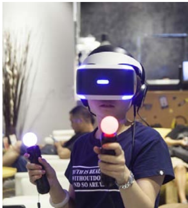
手柄上的灯泡和头显上的9个蓝色LED灯都是用于定位的
