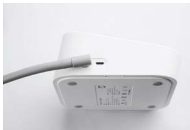
充电口为标准的 MicroUSB,任何相同标准的 Android 手机充电器都能直接插
