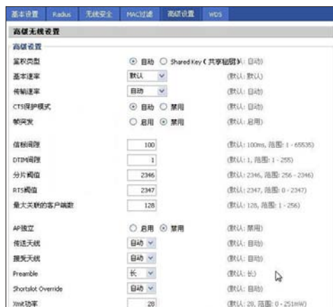
DD-WRT固件的高级设置最下方可调整发射功率
