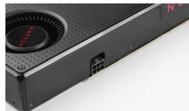
得益于新架构和新工艺,RX 480的功耗很低,仅仅用一个6pin接口即可满足供电需求
