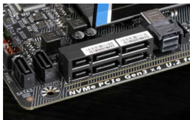
技嘉 Z170X-Designare 提供 U.2、M.2、PCI-E 三种高速 SSD 接口,还支持 RIAD 0 模式
