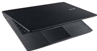
S5-371的体型较为小巧,铝合金C壳和镁合金机身设计让它的耐用性也达到了较高水准
