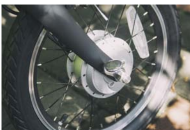
采用前轮250W电机驱动
