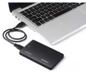
只有一个 2.5 英寸硬盘位的话,想要不重装系统,必须先利用 USB 移动硬盘盒装入固态硬盘接驳笔记本进行系统迁移,然后再将固态硬盘装入笔记本内的硬盘位
