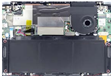
该机采用掀底盖维护的方案,但即便是拧下螺丝后也需要一番力气才能打开紧密贴合的底盖。就内部设计来说S5-371与大多轻薄本一样非常紧凑,而且布局很规范
