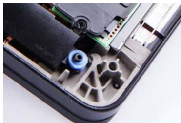
轻薄型高端本虽然无法采用框架结构，但边角的金属加固筋设计也让它在应对跌落磕碰时更有保障
