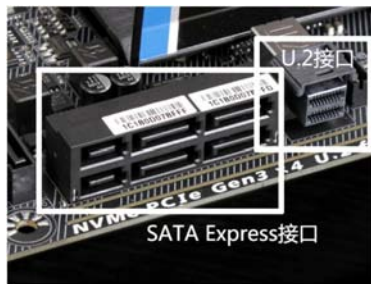
除了 M.2 和 PCI-E 插槽，U.2 和 SATA Express 也是两种高速硬盘接口
