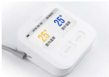
在不插电的情况下,点击任意按钮,屏幕上就会显示电量/日期/时间及室内外温度
