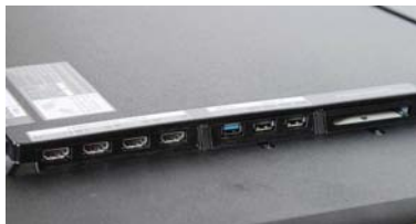
电视接口中,右侧的插槽即 CAM 卡槽
