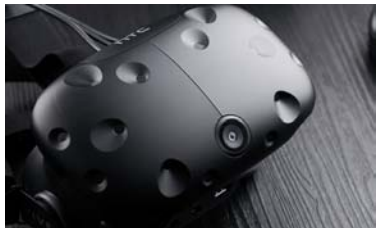
32个传感器加摄像头，不然你觉得为什么 HTC VIVE 定位那么精确？
