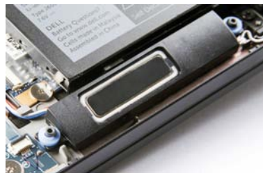
扬声器固定采用软垫圈，使得扬声器处于悬浮状态，也是目前中高端机型的流行趋势
