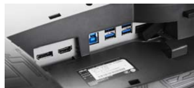
显示器提供了1个HDMI接口、1个DP接口以及4个USB 3.0接口，够用了
