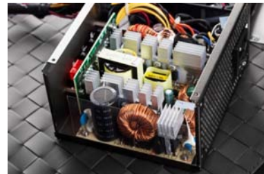
双管正激的架构,齐备的 EMI 电路保证了电源输出品质
