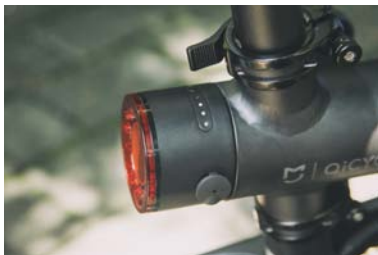
后车灯在主梁后位置,带有电量显示和充电口,跟电池是一体的,要取出电池更换,也需要将车座管抽出
