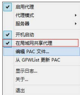
勾选“在局域网共享代理”的类似选项,局域网就可以获得 ShadowSocks 加速
