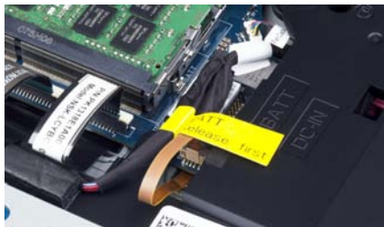
每一个接口和数据线都标注了用途和功能,相当贴心和严谨。电池连接线更是采用更醒目的黄色胶带,提示玩家在维护前先取下电池
