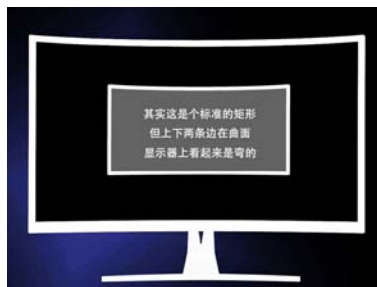
曲面带来的画面畸变是无可避免的,因此不适合精准的设计工作
