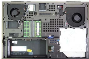
顶级本只要是非轻薄设计的产品，大多都会采用框架结构对内部元器件进行保护，像移动工作站甚至会采用金属框架，耐用性极强
