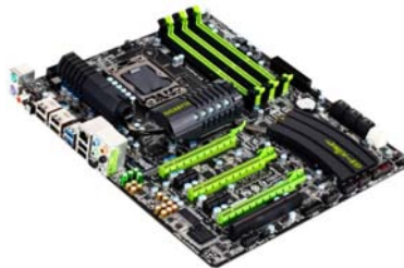
提供多个 PCI-E × 16 插槽的老主板，通过转接卡升级 M.2 固态硬盘很方便
