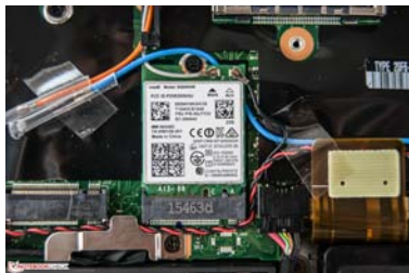
双天线网卡不少见，支持 802.11ac 规范的也不在少数，但能达到 867Mbps，同时还能实现超强搜寻信号能力的，唯有顶级型号，比如英特尔 Wireless-AC 8260
