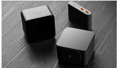
两个正方体激光定位器，一个扁扁的串流盒
