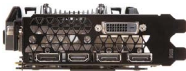
在视频接口方面,映众 GTX 1060 X3冰龙海量版提供了1个DVI接口、1个HDMI接口和3个DP接口的配置
