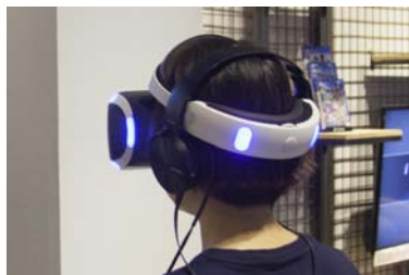
PS VR头显这种杠杆式的佩戴设计,让头颈都不会有压力
