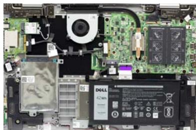
该机的可维护性很强,拧下 8 颗底部螺丝后配合撬棒就能打开底盖,电池是 42Wh,只有 2.5 英寸硬盘位,无法升级 M.2 SSD
