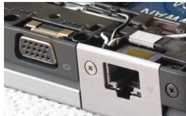
中高端机型往往对接口模块进行了强化设计，而且有框架结构限位，让它无法产生一丝位移，相当牢牢耐用
