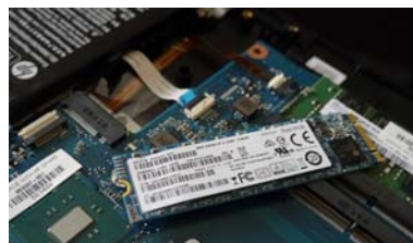
如果笔记本只安装了机械硬盘但预留了 M.2 接口,用户则可自行购买 M.2 固态硬盘进行升级,然后再将机械硬盘中的系统迁移到固态硬盘上,这种方案是最简单的
