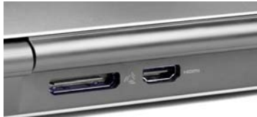
Alienware 17的背部预留了一个外置显卡扩展坞的专用接口,采用完整的PCI-E 3.0 × 16总线,支持一块公版双槽散热器顶级显卡,比如桌面版GTX 980 Ti
