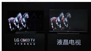
OLED 电视暗处细节完整, 而液晶容易泛白
