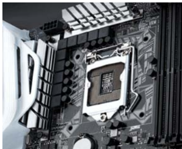
有 10 相数字供电的 Z170 主板,超频能力靠谱
