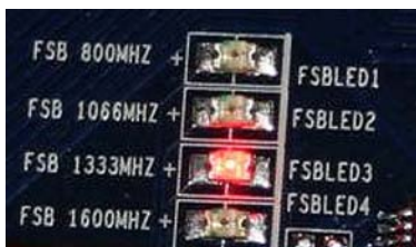
显示前端总线频率的 LED 灯光系统,方便监测超频状态
