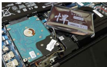
如果笔记本只有一个 2.5 英寸硬盘位,就只能单独购买 2.5 英寸的固态硬盘升级
