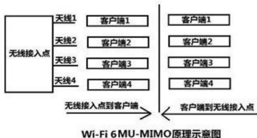
• Wi-Fi 6的MU-MIMO同一时间上下行各支持4个设备
