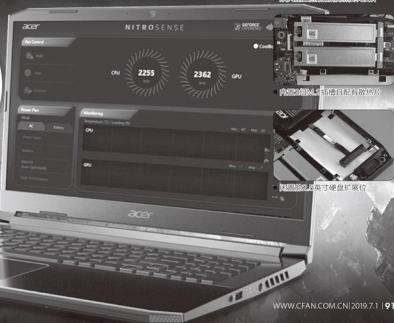
● 定制散热片适配M.2 SSD并配有散热位
