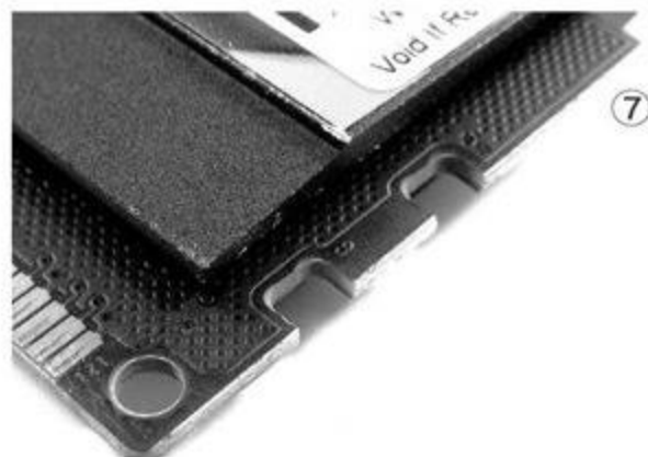
⑧ • 放大之后，电路板的铜电路层和总的分层数就非常明显了
