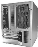
● 乔思伯C2使用ATX标准电源时的布局
