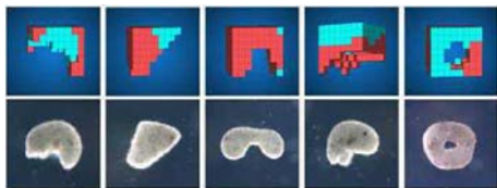
由计算机设计的机器人位于顶部,其真实生活的模拟物位于底部
