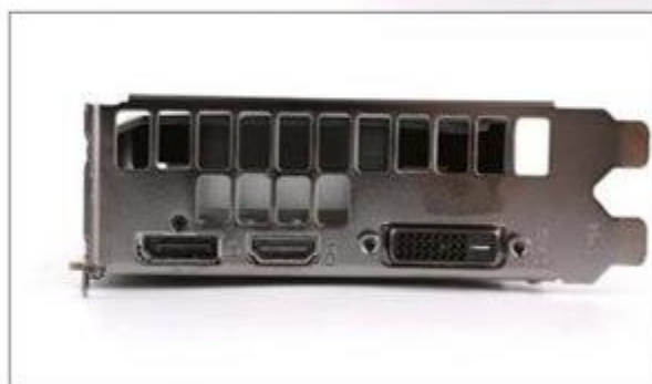
耕升GTX 1650 Super 追风接口配置为DP×1+HDMI×1+DVI×1组合
