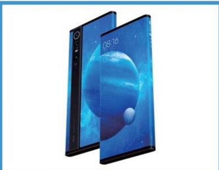
MIX Alpha彻底取消了手机两边的中框，除了给手机做“横梁”的相机模组部分，MIX Alpha的四周都是屏幕。
