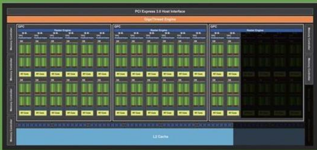
■ RTX 2060核心架构一览,可见被屏蔽的部分。
