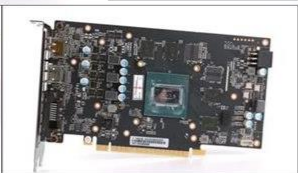
耕升GTX 1650 Super 追风采用了TU116核心，显存颗粒是来自美光的单颗1GB的GDDR6。另外，耕升GTX 1650 Super 追风采用了3+1相供电设计。
