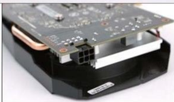
耕升GTX 1650 Super 追风的电源接口为单6pin设计
