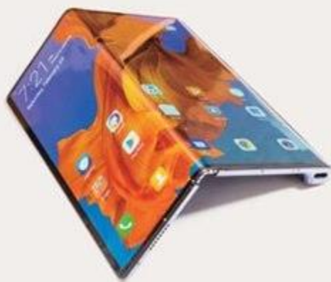
■ Mate X选用了基于柔性屏的鹰翼式折叠设计,并在机身中间位置使用了铰链结构,解决了折叠状态下的机身缝隙问题。
