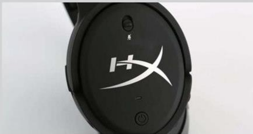
■ 左侧单元外壳部分集成了麦克风开关以及电源开关, 值得一提的是, 单元外壳也经过了类肤喷涂处理, 并且中间印刻了HyperX的Logo。
