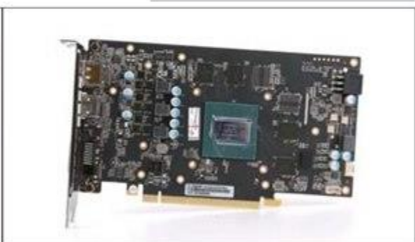
影驰GTX 1650 SUPER骁将采用了TU116核心，显存颗粒是来自美光的单颗1GB的GDDR6。另外，影驰GTX 1650 SUPER骁将的PCB上采用了全固态电容，高效稳定。
