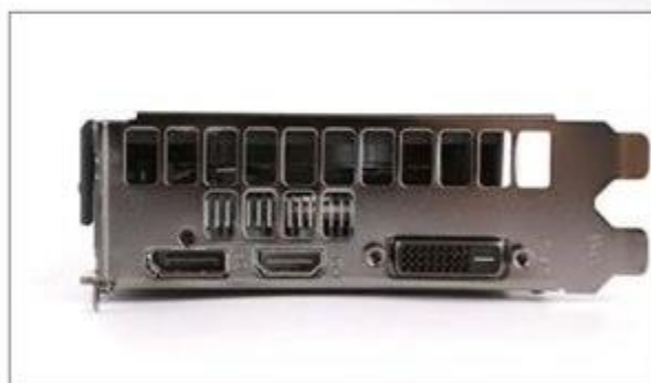
影驰GTX 1650 SUPER骁将接口配置为DP×1+HDMI×1+DVI×1组合
