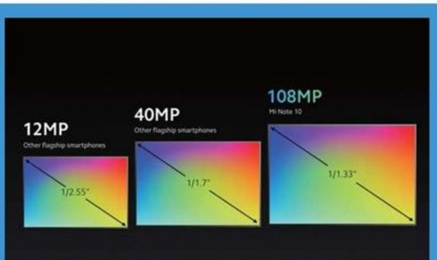
■ 小米CC9 Pro采用的ISOCELL Bright HMX是目前像素最高的，也是首款采用1/1.33英寸大尺寸的移动图像传感器。
