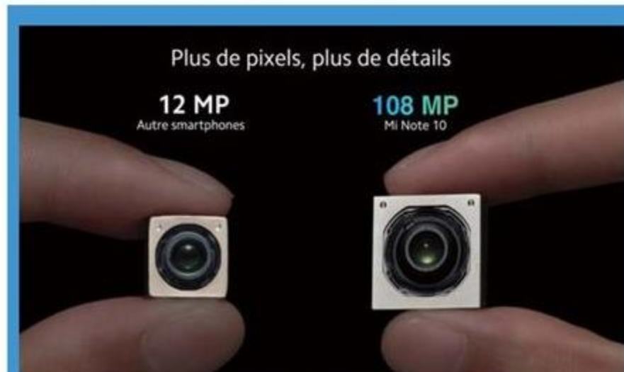
■ 高像素CMOS通常会有更大的面积，带来更多的进光量，可以提升暗光环境下的表现。
