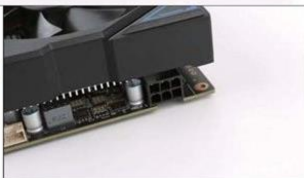
影驰GTX 1650 SUPER骁将的电源接口为单6pin设计
