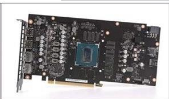
ROG-STRIX-GTX1650S-O4G-GAMING采用了TU116核心，显存颗粒是来自美光的单颗1GB的GDDR6。供电方面，ROG-STRIX-GTX1650S-O4G-GAMING采用了4+1相供电设计，电路设计还是非常严谨。
