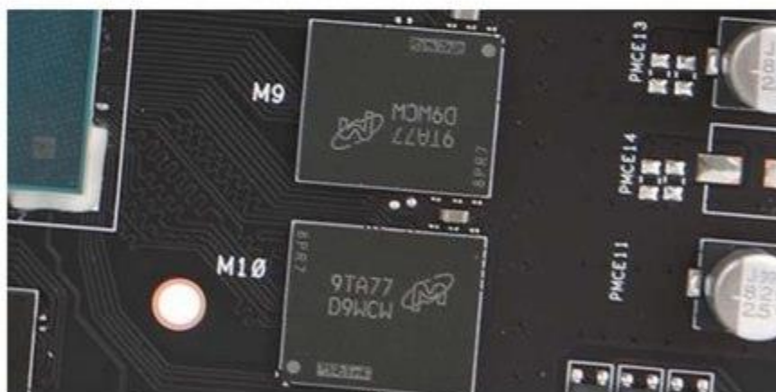
■ GDDR6显存以及更高的显存频率是GTX 1650 Super的一大优势之一
