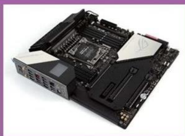
高端领域主要依靠新版X299主板,使得X299平台能提供72条可用PCIe 3.0通道。
