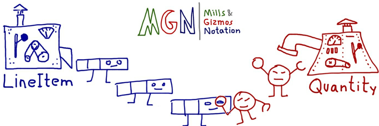
图 20-3: MGN 简图表示， LineItem 类生产了三个实例， Quantity 类生产了两个实例。其中一个 Quantity 实例从一个 LineItem 实例中获取存储的值
