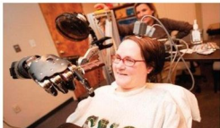
Scheuerman 大脑中被植入两块电极网格，与大脑中控制手臂和手掌的部位相连
