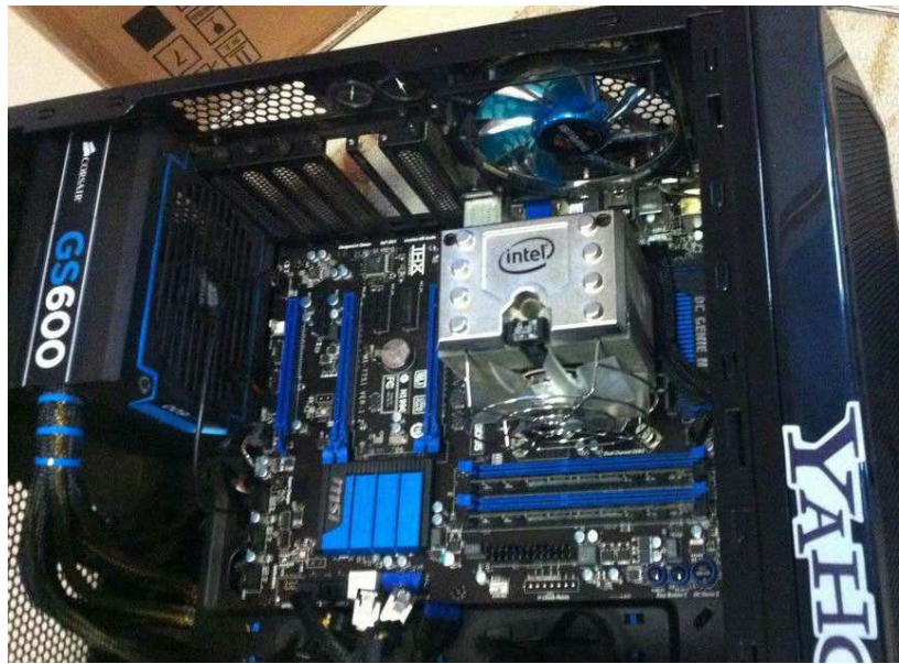
侧吹式散热器相当于在机箱内加上了一个风扇,所以也要注意风扇的风向
