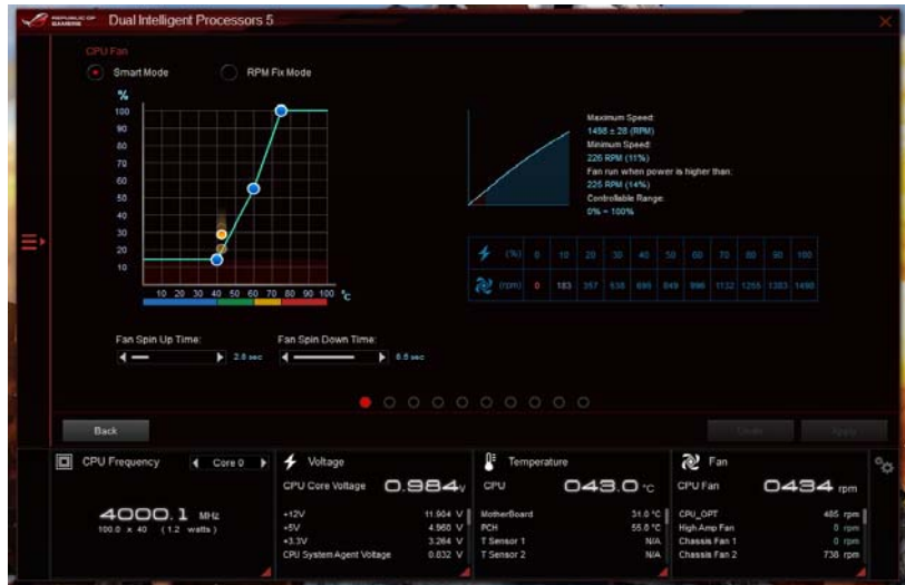
用华硕Fan Xpert 4软件可以实现对风扇非常精确的调校
