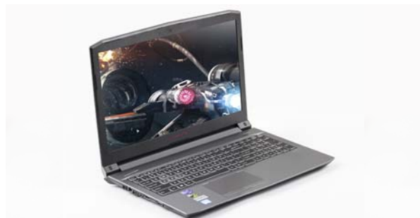
15.6英寸显示屏支持144Hz刷新率,采用72% NTSC色域AHVA面板,这在主流价位也是不多见的
