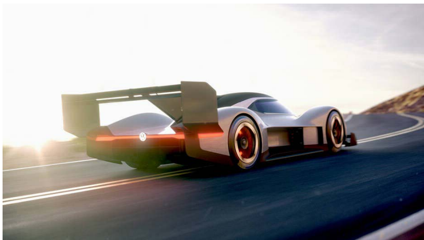
硕大的尾翼对空气稀薄的高原赛道而言尤为重要
