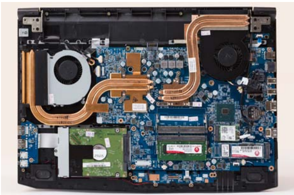
吾空Z15-8U电池采用了便于维护的外置设计,内部预留了内存升级插槽,处理器和内存均有双热管+独立风扇散热,效率也还不错
