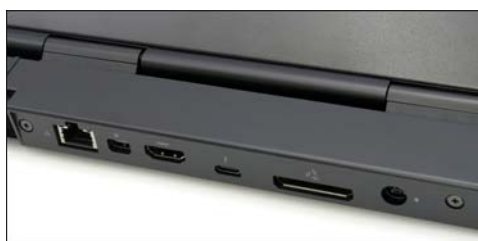
该机大量的粗线缆接口设置在机身背部,其中包含了一个 40Gbps 带宽的雷电 3 口,以及 Alienware 外接显卡扩展坞专用口
