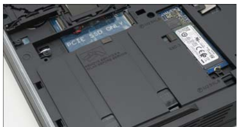
图中可见其框架设计非常复杂和精湛。该机带有 3 M.2 插槽,两个 2280 插槽和一个 2242 插槽。而这块扎实的大型框架下部,就是 99Wh 的大电池
