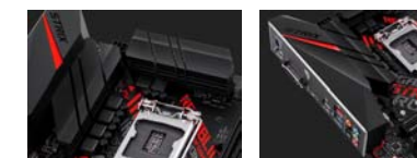
尺寸远超普通B360主板的MOS散热器,可以提供更出色的散热效果与稳定性
