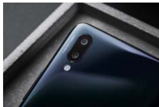
vivo NEX的后置摄像头采用了双核1200万像素(2400万像素感光单元)+副摄像头500万像素的组合
