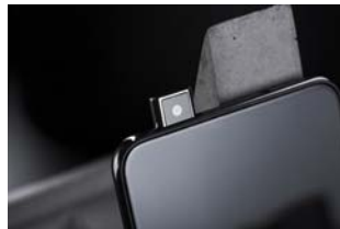
经过测算,从按下前置镜头切换按键到最终镜头升起工作,中间大概需要1秒的时间
