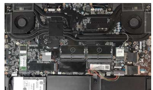
采用了4风扇(其中2个隐藏在主板下方)8热管散热,所以它可以在尽量轻薄的情况下满足极致性能配件的散热需求,而且还能继续升级M.2 SSD和内存
