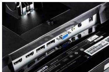
显示器提供了 1 个 VGA 接口、1 个 HDMI 1.4 接口、1 个 HDMI 2.0 接口和 2 个 DP 接口,视频接口非常的丰富
