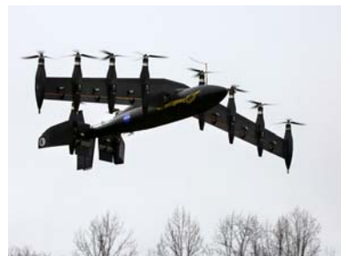
通过“尖端异步推动器技术”实现静音的 GL-10 用到了 10 组旋翼
