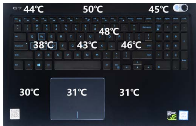
G7双考机半小时后C面温度图。WASD按键38℃不算高,最热处是数字键8、9、0及周围一圈,可以达到48℃。腕托、触控板部分很凉爽。总体来说,游戏操控没有问题,但键盘区域右侧明显很热——而实际玩游戏时,C面温度其实没有这么高
