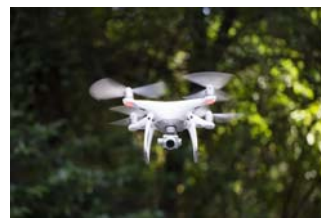
精灵4 Pro可以实现前、后、左、右四个方向的自动避障
