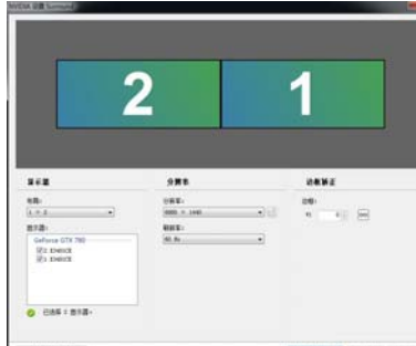
选择组建 Surround 显示器的模式,用 PBP 来实现的话,直接用默认值就好
