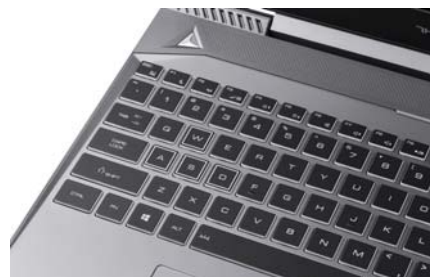
雷神 911Air 的键盘支持白色背光,手感较好,开机键独立于 C 面左上方,2 个 3W 扬声器的开孔也在键盘上方
