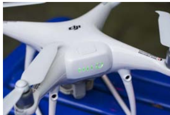
精灵4 Pro的这块5870mAh的电池能够维持最长约30分钟的飞行时间
