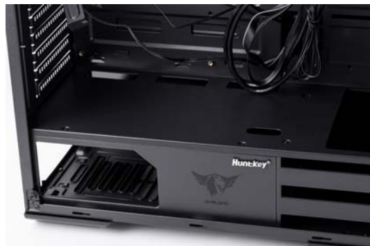
机箱电源仓隔板并不是完整的一块,而是留有一块缺口,这样设计的目的在于可以将电源上的LOGO显示出来
