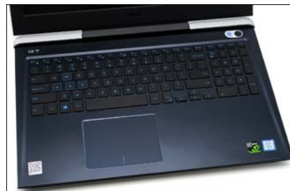
G7的电源按键整合了指纹识别功能,识别/响应非常迅速;键盘的键程不算长,但很快;有数字小键盘
