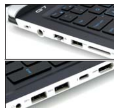
G7的接口非常丰富,带有雷电3和HDMI2.0。更重要的是,从接口处可以看出该机的外框架有多厚实,绝对的耐操机型
