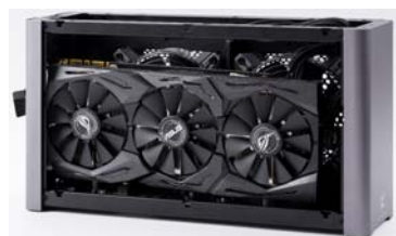
安装华硕 ROG STRIX-GeForce GTX1070TI-A8G-GAMING 之后,显卡盒中空间还有富余,对显卡的兼容性做得很不错
