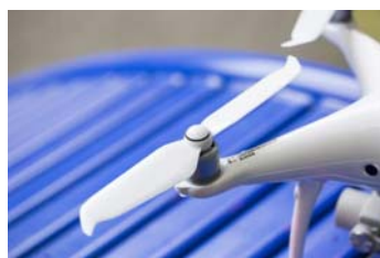
优化气动外形后的桨叶能够有效减少运行过程中的噪声
