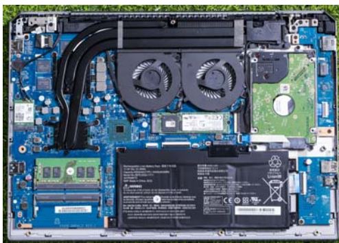
内部预留了内存升级位,散热布局比较有意思,考机温度不算低,但游戏性能还是可以稳定发挥
