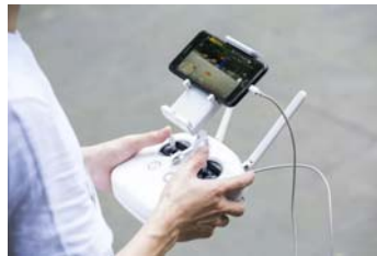
精灵4 Pro换装了更强的OcuSync图传系统,具备更强的抗干扰能力以及流传输能力
