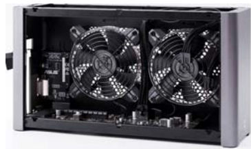
外置显卡盒还有 2 个 120mm 风扇,足以应付高端显卡的散热所需
