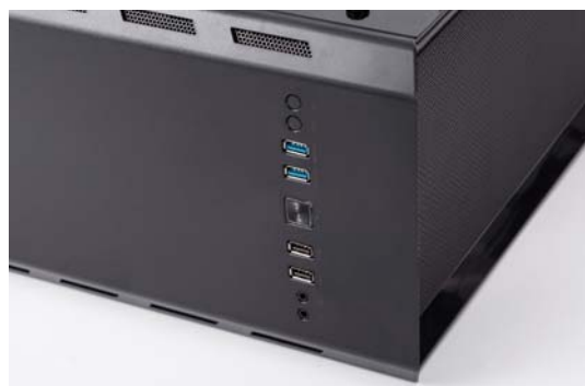
机箱顶部提供了2个USB 2.0和2个USB 3.0接口,还有3.5mm的麦克风和耳机接口
