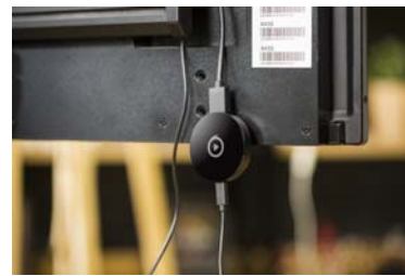
可以通过电视的 USB 接口供电,将它连接在电视的 HDMI 接口即可使用
