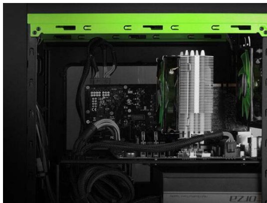
高端风冷散热器体积庞大,机箱空间不够会出现“顶盖”的情况
