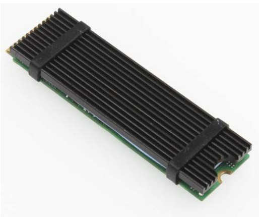
橡皮筋固定 M.2 散热片简单有效
