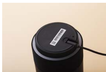
天猫精灵X1上只有静音、音量增减3个按钮,大部分操作都要靠语音控制
