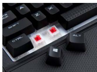
键盘采用了Cherry红轴,可以看到机械轴四周多了1圈硅胶套
