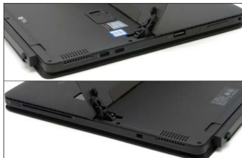
USB标准大口和两个雷电3接口(其中一个也是充电口)设置在左侧,同时还有3.5mm音频口和音量增减键。机身右侧是Smart Card读卡器槽(这也是一个安全性的功能设计)和Home/Win按键(用于平板状态时返回主界面/切换到当前应用)。注意,后支撑盖掀开后还能看到TF读卡器和uSIM卡槽二合一机构(上图Win徽标贴旁)
