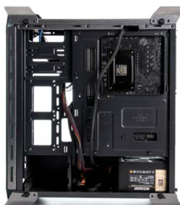
线材长度足够在大尺寸机箱中走背线,600mm 长度的 12V CPU 供电线走线非常轻松
