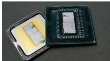
AMD 锐龙处理器内部使用高成本焊料填充,散热效果好于硅脂填充
