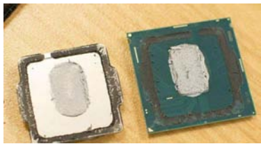
Intel 酷睿 i7 8700K 内部使用廉价硅脂填充,常规风冷温度轻松破 90℃
