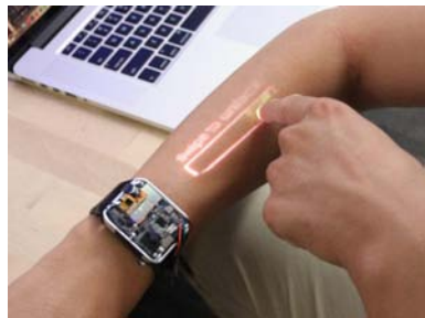
Lumi Watch利用滑动解锁过程来进行投影平面校准
