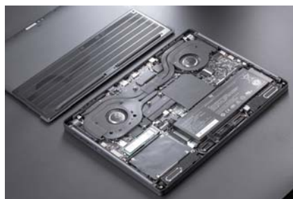
3+2 组合 11mm 热管,金属转叶双风扇,四出风口,全元器件散热片覆盖……小米游戏本的散热规格没得说
