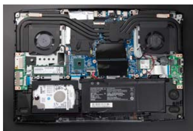
内部设计很紧凑,但同时预留了 M.2 插槽,内存可以继续升级,HDD 甚至有胶垫缓冲
