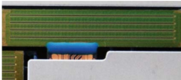
采用安捷打印技术的喷打其喷头非常宽大
