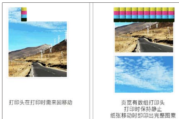
传统喷打(左)和采用安捷打印技术的喷打(右)对比
