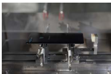
R15玻璃后盖表面应力测试
