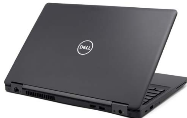
该机的接口分布在机身的两侧和后部,后部主要是“粗线缆”的接口,降低了线缆对用户的干扰
