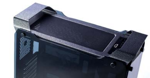
机箱顶部的散热孔,覆盖有磁吸式防尘网
