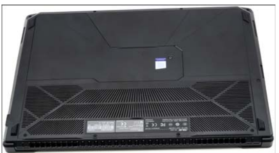
该机的散热在机身后部的左右两侧,从这个图可以清晰看到两边的排气槽和底部进气格栅。机身后部的垫脚略高,用于加大底部进气空间
