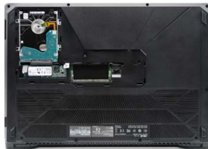
要拆卸底盖需要拆掉整个底盖的全部螺丝,不过该机提供了一块小盖板,方便用户对硬盘(SSD 和 HDD)和内存进行更换及增加(该机有两根内存插槽,默认占用了一根,把空余的一根设计在小盖板空间内)
