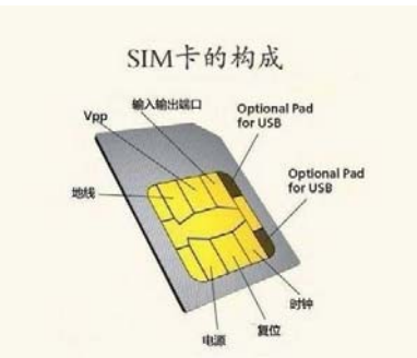
SIM卡实际上由不同功能部分构成
