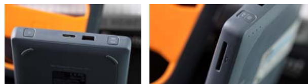
电源键、USB 3.0/USB 2.0(导入) SD 3.0插槽被放置在机身侧面接口和备份按钮都在顶部
