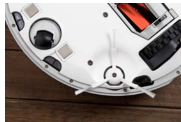
小瓦扫地机器人的清扫系统由风机、主刷、边刷三个部分组成,主刷和边刷负责清扫,风机负责吸附
