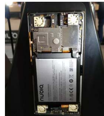
努比亚游戏手机的内部集成四颗小型风扇,提升散热效果
