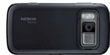
诺基亚 N86 的镜头盖上注明 2.4 ~ 4.8 的数字代表了其可变光圈范围
