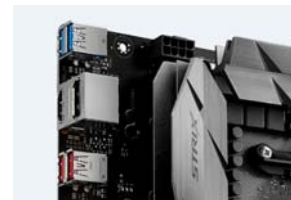
主板提供DP+HDMI双视频接口,连接高端显示器和平板电视都没问题
