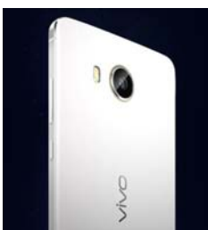
2014 年发布的 vivo X 成为首款具备 F1.8 光圈 + 光学防抖的机型,旗舰手机也整体向 F1.8 光圈迈进
