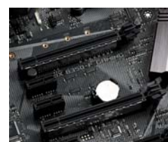
显卡插槽采用金属装甲加固,升级超高端独显也毫无压力,额外的PCI-E全长插槽也可升级高速固态硬盘
