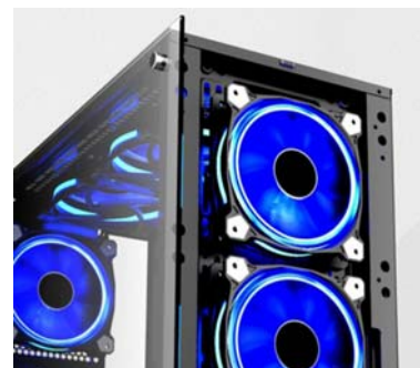
前面板之下预留了 3 个风扇位,也可安装 240mm 水冷排
