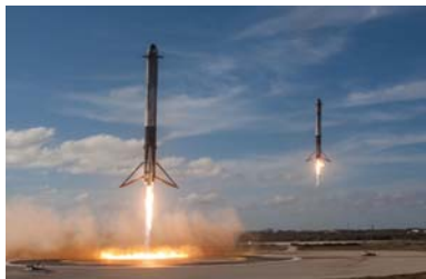
一级助推火箭几乎同步完成垂直回收
