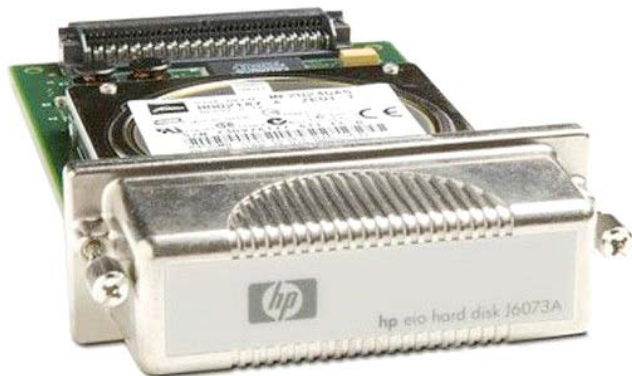
部门级打印机都带有存储硬盘
