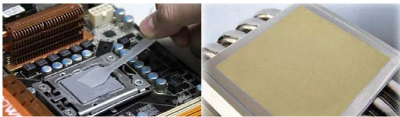
硅脂只需要均匀地涂抹薄薄的一层即可,太多太少都会影响散热效果
