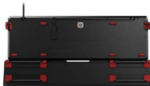
键盘背面有三向导向槽,方便用户选择自己习惯的出线方向
