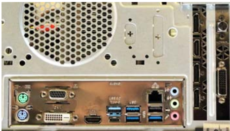
主板背部接口很充裕,还有USB Type-C, GTX 1060的显示输出方案较多
