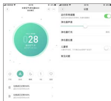
两侧滤芯的寿命可以单独显示,支持童锁功能
