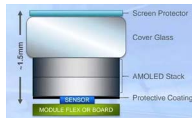
vivo采用的正是Synaptics量产的Clear ID FS9500传感器,依靠光学技术,可以直接封装在AMOLED显示模组中,厚度可以控制在1.5mm以内
