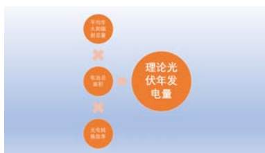
光伏设备理论年发电量简略计算公式
