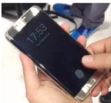
汇顶科技在去年MWC上以三星S7 Edge为原型机,展示了光学屏下指纹,将指纹识别集成到OLED显示屏中,触摸屏幕指定位置可实现指纹识别
