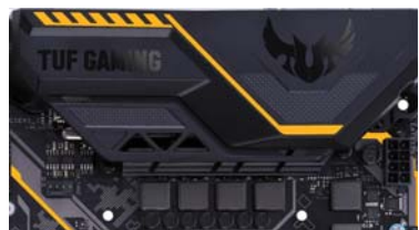
配有 TUF 专属 LOGO 的 MOS 散热装甲上还具备防滑纹和步枪护木外观元素,军事风格凸显
