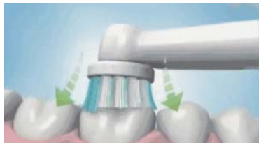
声波牙刷是电机带动刷头近似声波的振动频率做高速左右摆动,旋转电动牙刷是依靠传动轴带动刷头旋转,本质上它们都是通过机械性的摩擦来清洁牙齿
