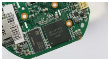
萤石 C6H 主控板上的主控芯片和 WiFi 网络芯片
