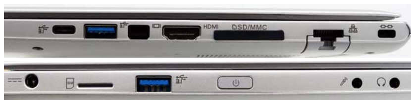
虽然是轻薄本,但接口却实用性很强,两个 USB3.0 外加 USB3.1 Type-C 的数据接口很充裕,除此之外显示输出也有 HDMI 和 Mini DP 两种,更是搭载了千兆有线网卡,除此之外电源键也在侧面
