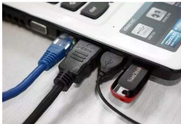
在连接USB音箱之后,再在同一组USB接口上插入其他设备,易产生干扰
