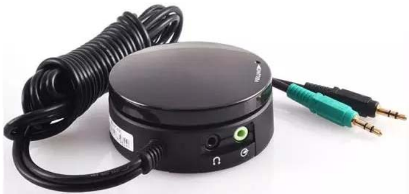
电位器损坏导致的噪音,可通过固定音量,增加线控器来解决
