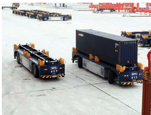
无人驾驶的AGV小车将集装箱准确运输至目的地
