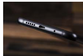
依然没有Type-C接口,单独的一个开孔是麦克风,孔有点大
