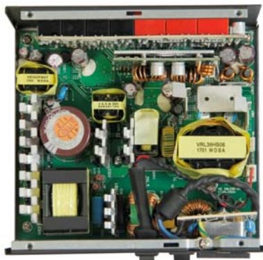
MVP P850 采用 100% 全日系 105°C 电容 +100% 固态电容,MTBF 达 10 万小时
