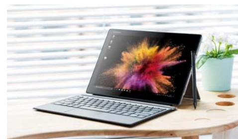
Miix 520 采用拔插分离式设计,但却依然采用 15W TDP 的 Core i5 8250U 四核处理器,性能与传统轻薄本基本无差
