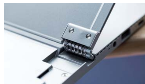
无级旋转 0°~160°,Miix 520 采用了联想标志性的表链式转轴
