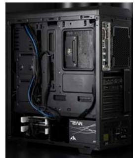
MVP P850 采用扁平线材+蛇皮网包裹的组合,线材长度应付各类机箱也绰绰有余
