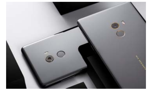
由于顶部空间让给了屏幕、听筒、超声波距离传感器等组件,所以大幅提升且支持光学防抖的MIX2(左)摄像头有一定凸起
