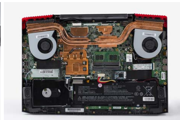
掀底盖维护的方式简洁明了,双风扇散热效率足以满足大型游戏长时间的运行需求,内存与 M.2 SSD 还能继续升级,可玩性很强
