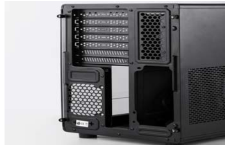
左右分层充分利用了机箱空间,并且将散热区域隔离,主板区域和电源区域互不干扰
