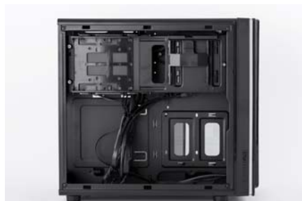
左侧为电源层,包括了一体式硬盘支架和免工具硬盘位
