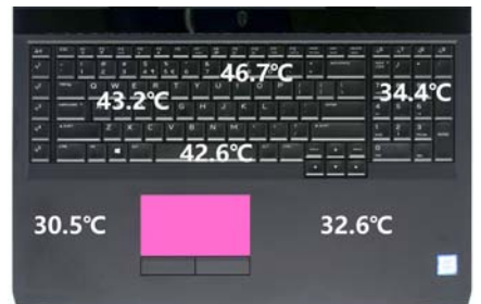
▲高负载下的C面温度,热源集中在键盘上位置,总体热感较低
