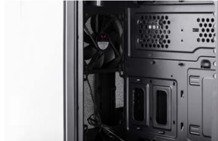
前面板后方最多可以支持240mm水冷排,并设置了防尘过滤网
