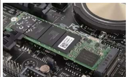
NVME的PCI-E固态硬盘将占据4条PCI-E通道
