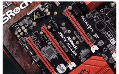
第一条PCI-E显卡插槽将直接占据处理器16条PCI-E通道
