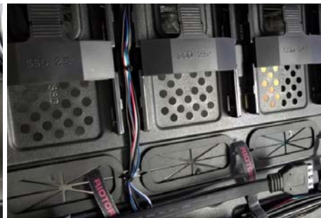
主板支撑板背面设置了4个2.5英寸固态硬盘位侧插式硬盘位设计
