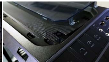
透明顶盖之下是可拆卸防尘网,散热防尘做得很细致
