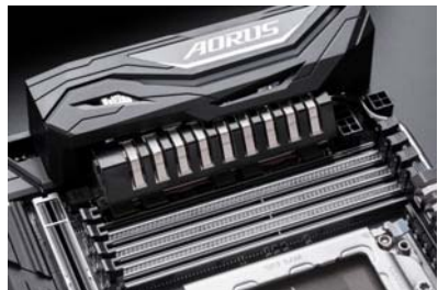
X399 AORUS Gaming 7提供8Pin+4Pin双供电, 保证180W TDP的Threadripper稳定工作
