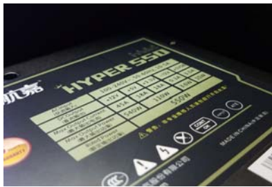
+12V输出可达45A，应付强力独显毫无压力
