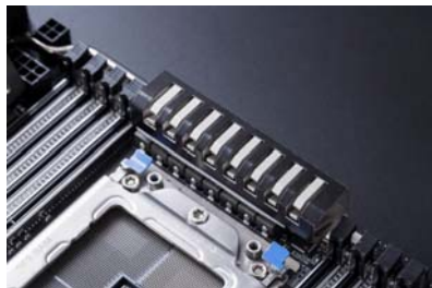
8相数字供电能够满足Threadripper超频的需求
