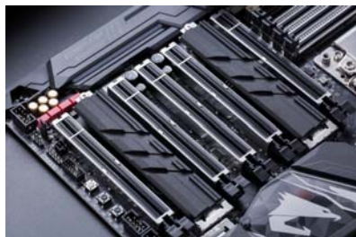
板载5条PCI-E 3.0全长插槽, 不但支持4卡互联, 还全部加装合金装甲, 性能强大更耐用
