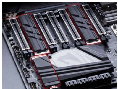
板载3个32Gbps带宽的M.2插槽, 同时全部覆盖精致的散热片, 与主板风格浑然一体
