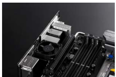
主板I/O面板区域的装甲中,隐藏了一个为供电电路提供主动散热的风扇
