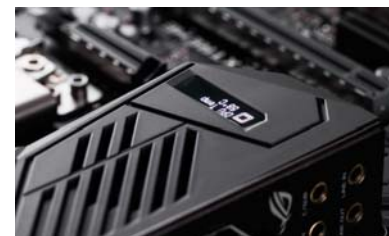
LiveDash OLED不但可以显示系统状态参数,还能显示自定义图案与文字
