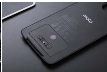
摩电mini更加轻薄，可提供额外2220mAh电量，不能单独充电，手机充满之后就会继续给它充电
