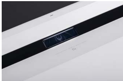
投影灯采用了光峰光电的APLD3.0激光光源技术,机身两侧有红外感应探测,当人进入到投射区域时会有提示,并降低亮度
