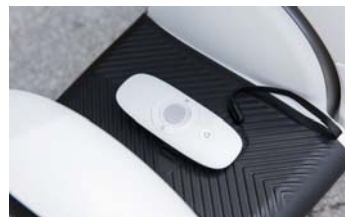
通过中间的摇杆遥控操作更方便,左右两个分别是跟随模式和一个可以自定义功能的按键
