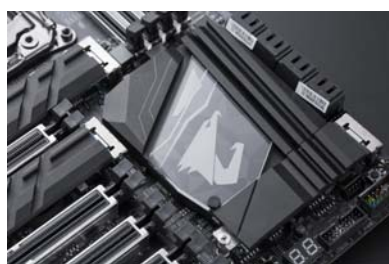
为了更好地支持 8 条内存超频,技嘉为这款 X299 提供了双 8Pin 供电,而一般 X299 是 8Pin+4Pin 的组合
