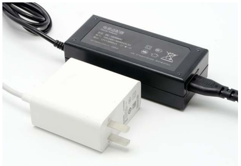
MateBook D 的额定输出 60W 适配器十分小巧, 甚至比一些 40W 输出的还要迷你一点, 降低了旅行重量
