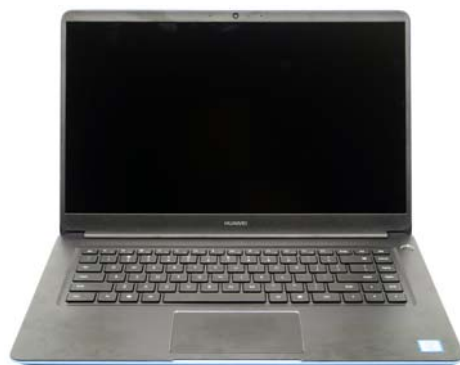
华为 MateBook D 采用了时下流行的微边框设计, 1.9kg 的体型在 15.6 英寸本里也算轻薄
